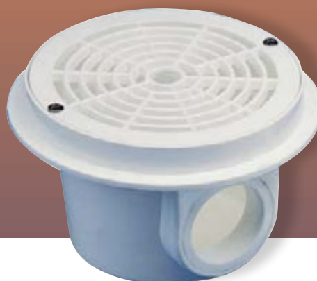
A - Ralo de fundo ABS circular Ø200 mm saída lateral 2" e inferior 1 1/2"
