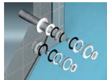
Pormenor de instalação da boca de aspiração Piscina Liner
