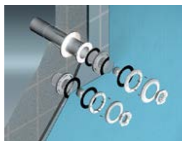
Pormenor de instalação da boca de impulsão Piscina Liner
