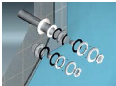
Pormenor instalação Passamuros Piscina Liner
